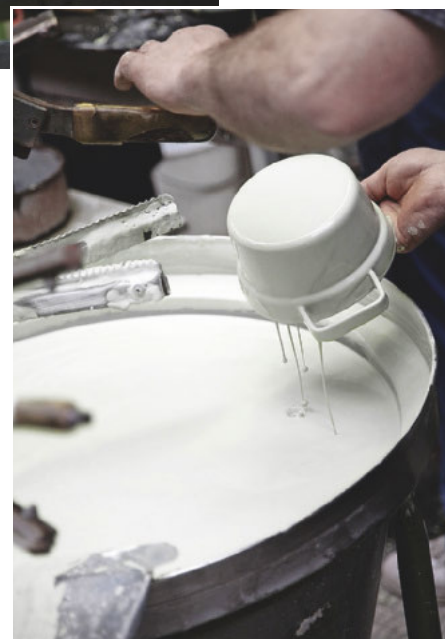
Vor dem Brennen werden einzelnen Teile in die Emailfarbe getaucht.
