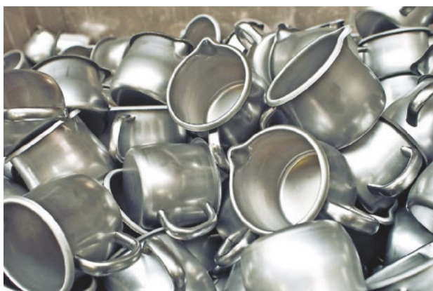
Erster Produktionsschritt ist die Herstellung der Metallrohlinge.
