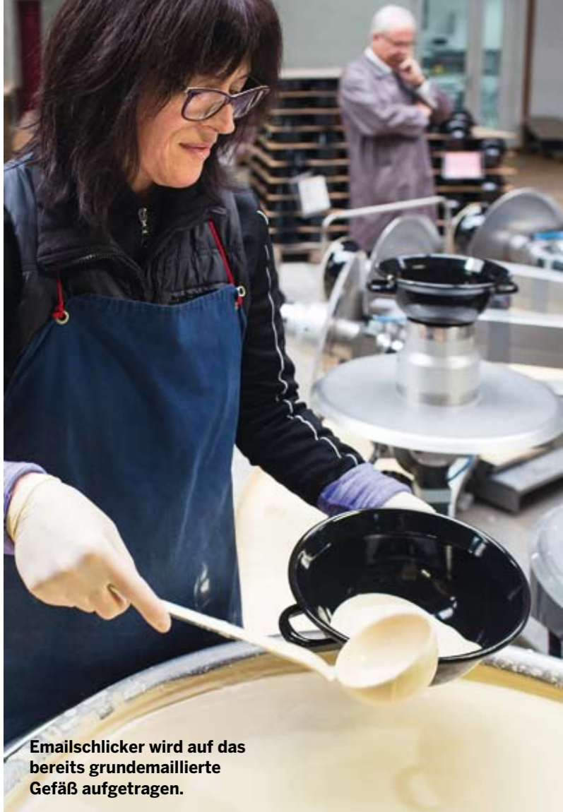
Deckemail verleiht dem Geschirr seine Farbe und eine glatte Oberfläche.
