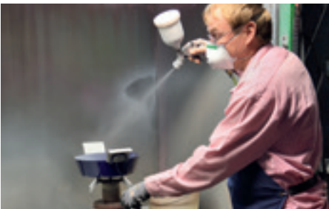
Bei Kleinserien wird die Emailglasur in der Spritzkammer aufgetragen.
